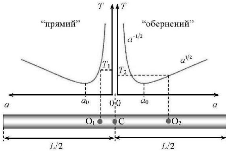
**Рис.2.2.** Залежність періоду коливань  $T$  фізичного маятника від відстані “ $a$ ” між точкою підвісу та центром мас. Оси  $T$  вважати такими, що співпадають.
