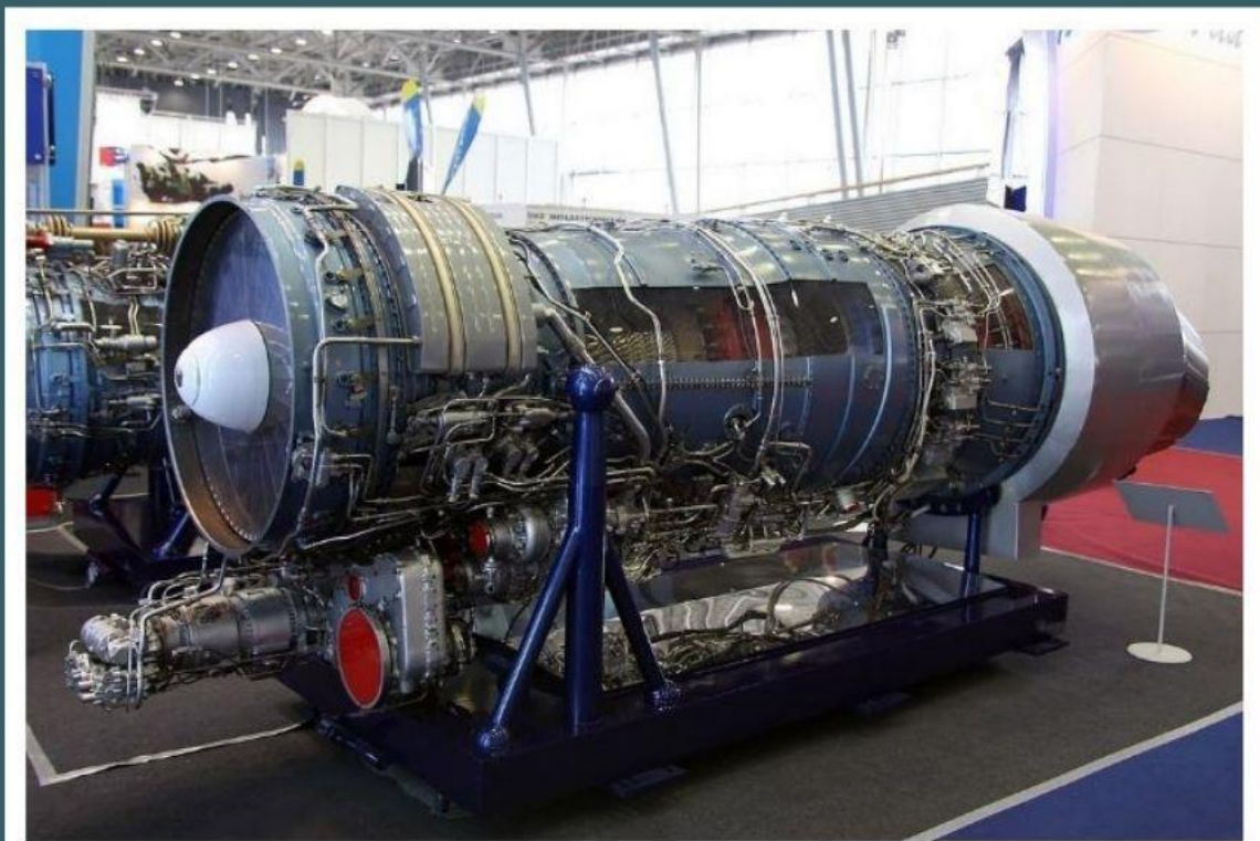
Двигун АЛ-31 ФЗ конструкції А. М. Люльки
