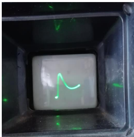
Рис.9. Осцилограма вольтамперної характеристики тиратрона.
