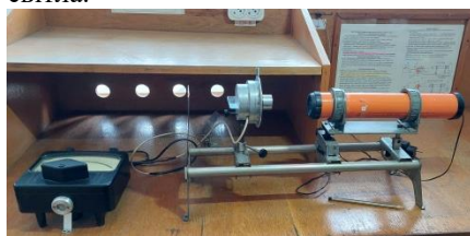
Рис.9.б. Експериментальна установка для перевірки закону Малюса.
