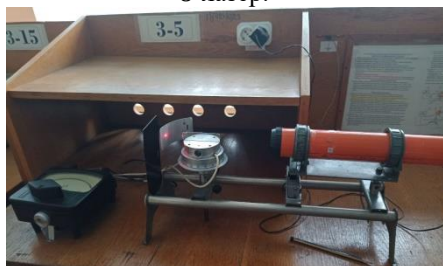
Рис.9,а. Експериментальна установка для дослідження поляризованого світла.
