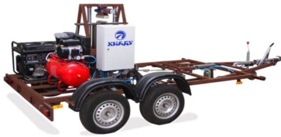
Рис.3. Установка динамічного навантаження УДН-ХНАДУ
