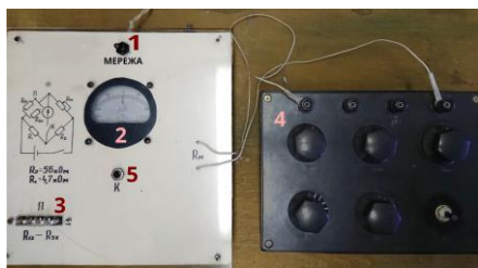
Рис.10 Лабораторна установка. Тут 1 - підключення до мережі, 2 - гальванометр, 3 - вмикання в схему невідомих опорів R_x , 4 - магазин опорів R_m , 5 - ключ K .
