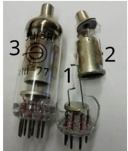
Рис.3.4. Електронна лампа, яка використовується в лабораторній роботі. 1- катод, 2 – анод, 3 – загальний вигляд лампи.
