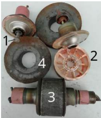
Рис.3.3.Електронна лампа, яка використовується в магнетроні, що показаний на рис.3.2 і 3.3: 1- катод, 2 – анод, 3 – загальний вигляд лампи, 4 – магніти.
