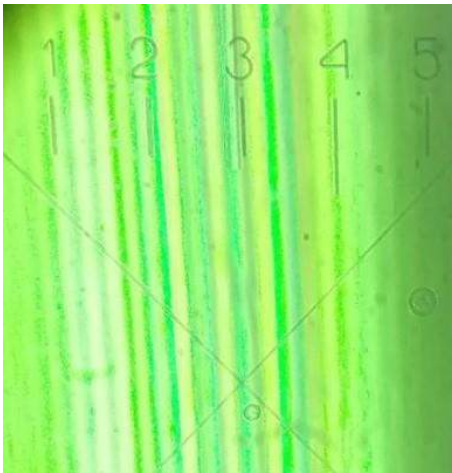
Рис.6.11. Інтерференційна картина в окулярі мікроскопа для різних світлофільтрів.
