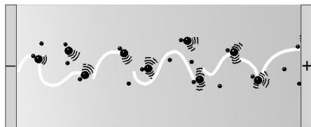
Рис.4. Порушення правильності атомного хвилеводу тепловим рухом атомів. Позначення: ● — іони кристалічної решітки; • — електрони.
